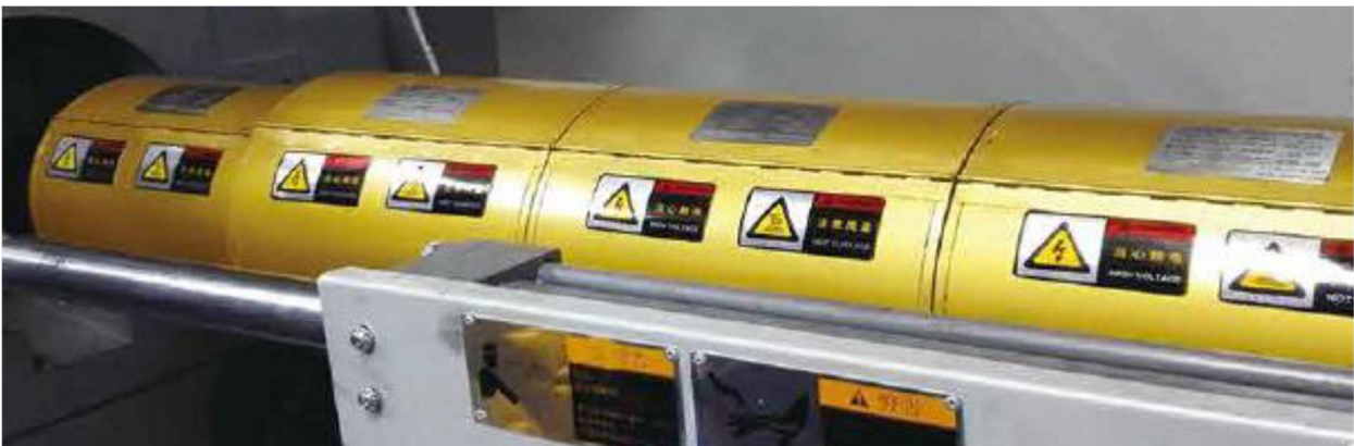
Sistema di riscaldamento a infrarossi di BKT per l'unità di iniezione.
