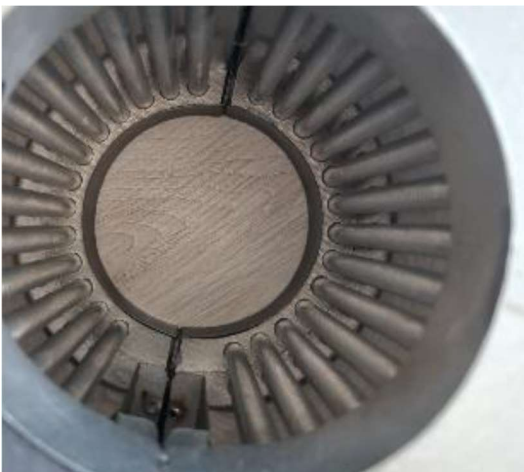
Sistema di riscaldamento a infrarossi di BKT per l'unità di iniezione.
