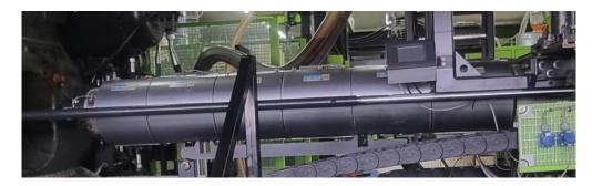
Welche Ziele erreicht man mit dem Einsatz von Infrarot- (IR-)-Heizbändern?
